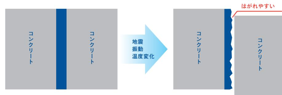
最適な材料を、最適なタイミングで注入することで、止水効果を最大化します。
