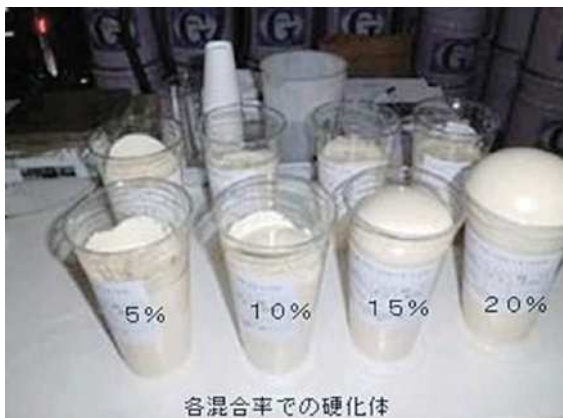
写真-4 ハイセルOX-1Xの混合割合と硬化体の形状
