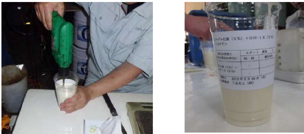
写真-Ⅱ-4-3 硬化混合試験状況
